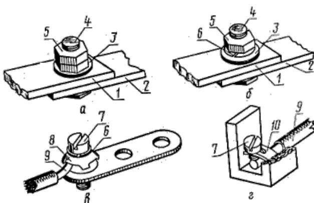
а - с контргайкой; б - с пружинной шайбой; в - однопроволочная (многопроволочная) жила провода (кабеля) сеч. до 10 мм<sup>2</sup> с изгибанием в кольцо; г - однопроволочная (многопроволочная) жила провода (кабеля) сеч. до 10 мм<sup>2</sup> без изгибаия в кольцо
