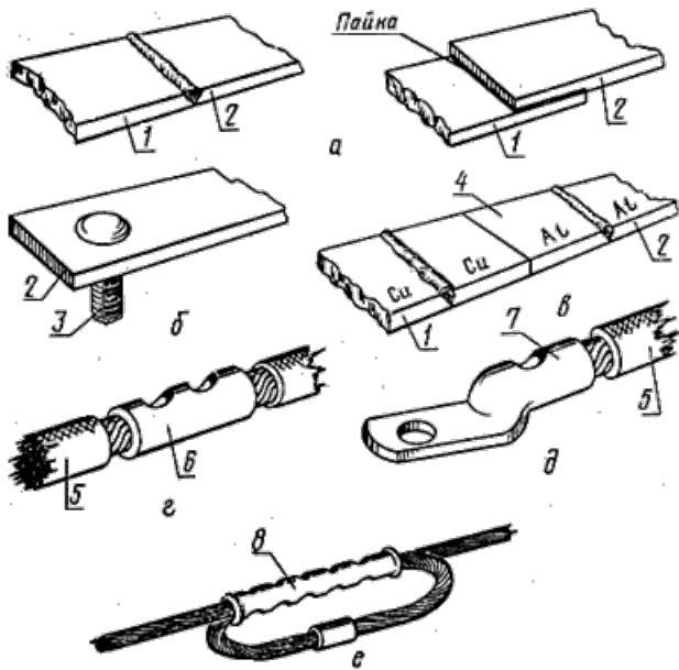
а - сваркой или пайкой; б - со штыревым выводом сваркой; в - сваркой через переходную медно-алюминиевую пластину; г - соединение жил проводов (кабелей) через соединительную гильзу опрессовкой; д - соединение жилы провода (кабеля) с кабельным наконечником опрессовкой (сваркой, пайкой); е - соединение жил проводов в овальных
