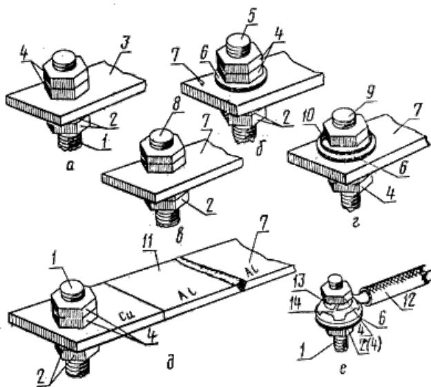
а - проводник из меди, твердого алюминиевого сплава или алюминия с защитным металлическим покрытием рабочей поверхности; б, в, г - алюминиевый проводник; д - алюминиевый проводник через переходную медно-алюминиевую
