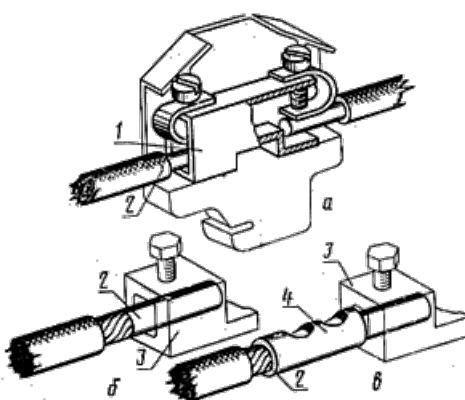
а, б - однопроволочная (многопроволочная, сплавленная в монолит) жила; в - многопроволочная жила, оконцованныя кабельным наконечником
